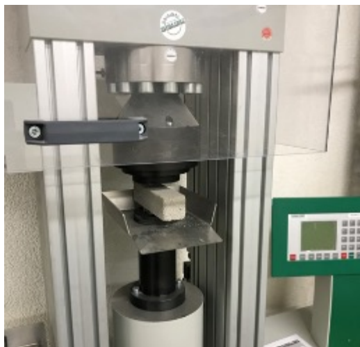
Prueba de resistencia a la compresión
