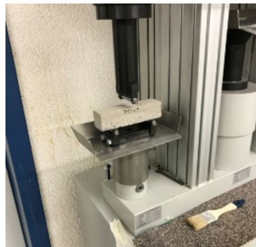
Prueba de resistencia a la tracción por flexión
